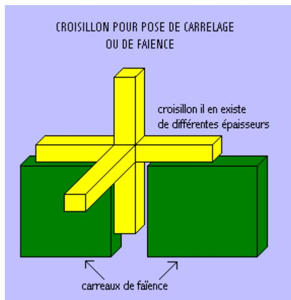
Continuer sans oublier de poser les croisillons de manière à respecter la largeur du joint, et à caler les carreaux. Lorsque vous êtes à l'extrémité de la rangée, vérifier qu'aucun carreau ne dépasse en appliquant la règle. Contrôler que tous les carreaux sont bien alignés horizontalement. Attention de ne pas déplacer de carreau car la colle n'est pas encore durcie. Si tout est bien, poser le deuxième rang de la même façon et ainsi de suite.
